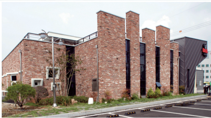
대지위치 : 전라북도 군산시 나운동 549-9번지 / 대지면적 : 1,289.00㎡ / 건축면적 : 408.84㎡ / 연면적 : 398.81㎡ / 구조 : 철근콘크리트 / 용도 : 근린생활시설 층수 : 지상 1층 / 외부재료 : 고벽돌치장쌓기, 접합강판거울접기
