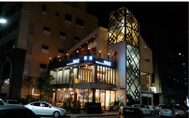
대지위치 : 전라남도 순천시 왕지동 856-7 / 대지면적 : 421.20㎡ / 건축면적 : 187.38㎡ / 연면적 : 462.22㎡ / 건폐율 : 44.48% / 용적률 : 109.73% 구조 : 철근콘크리트조 / 용도 : 근린생활시설, 주택 / 외부 마감재 : 노출콘크리트, THK0.6 프린트강판, THK24 로이복층유리, 고벽돌 치장쌓기
