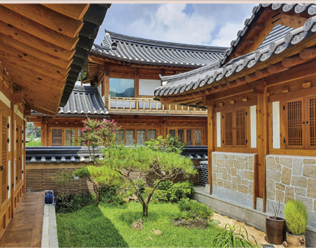
대지위치 : 서울특별시 은평구 연서로 50길 7 / 대지면적 : 236.1㎡ / 건축면적 : 92.76㎡ / 연면적 : 256.72㎡ / 규모 : 지하 1층, 지상 2층 주용도 : 단독주택 및 제1종근린생활시설 / 구조 : 한식목구조(전통한옥), 지하 철근콘크리트조 / 주요 마감 : 한식기와, 건식벽체 위 회벽마감
